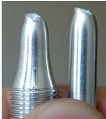
Figure III.4. Faciès de rupture typique pour un matériau ductile (alliage d'aluminium) [42].
