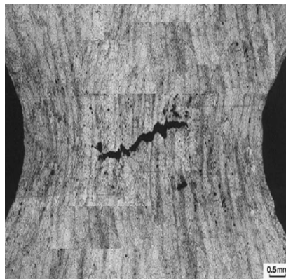
Figure. I.22. Coupe de la partie strictionnée d'une éprouvette en acier faiblement allié. On observe des cavités au sein de la partie strictionnée. Au centre elles se sont rejointes pour former une fissure (avec l'autorisation d'Hermès Science)[28].
