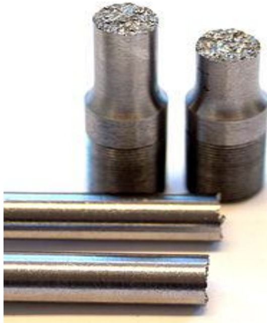
Figure III.5. Éprouvette rompue d'un matériau fragile (fonte). [Éprouvette rompue d'un matériau fragile (fonte)] [41].
